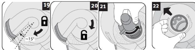
Nehmen Sie den Separator samt Separator-Deckel aus dem Staubbehälter. Entriegeln Sie den Separator-Deckel. Nehmen Sie den Separator-Deckel ab. Entnehmen Sie den Separator und entsorgen Sie seinen Inhalt in einen Mülleimer.
