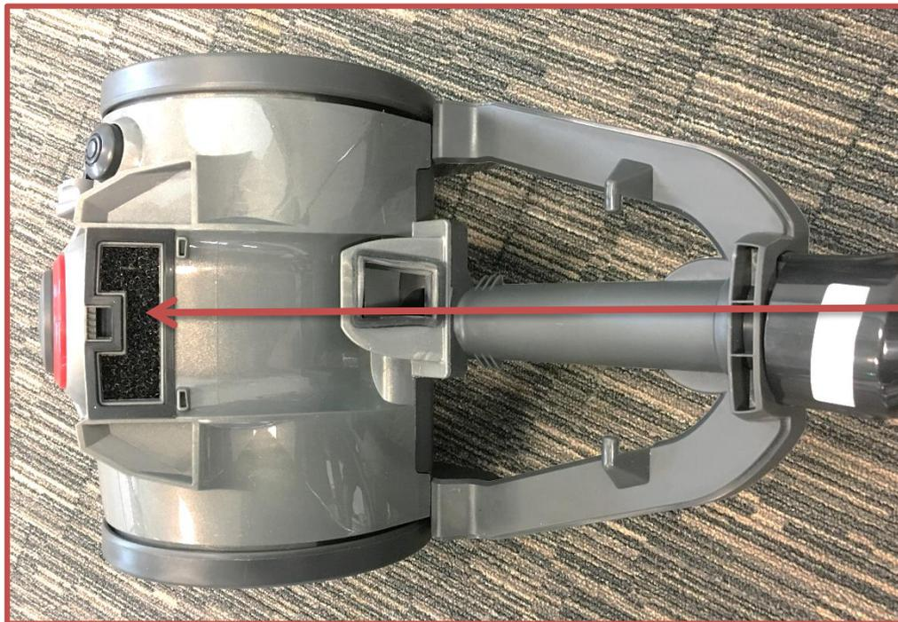
Schließen Sie das Gerät an, und entnehmen Sie den Staubbehälter. Schalten Sie das Gerät ein, und halten Sie eine Hand über den Motorsauganschluss (siehe Abbildung). Hier sollte eine starke Saugleistung wahrnehmbar sein.
