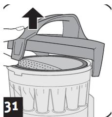
Drücken Sie die obere Staubbehälterdeckel-Entriegelung
